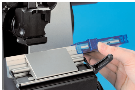
Einführen der Mikrotom-Einmalklinge
