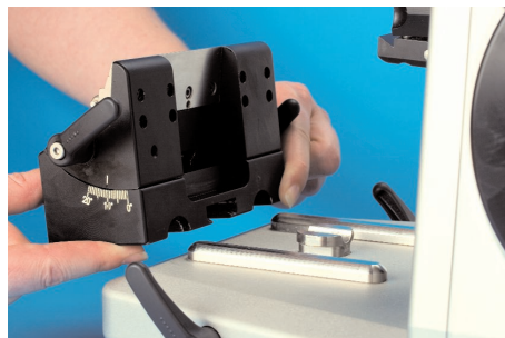
Einsatz des Einwegklingenthalers in die Präzisionsführung
